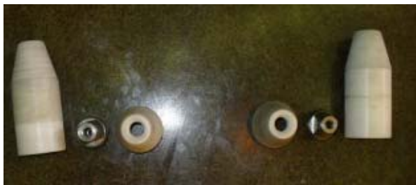
Figura 04: Acoplamentos cabo-corda para condutores com bitolas de 35 mm e 70 mm.
