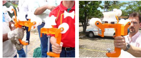
Figura 01: À esquerda podem ser vistas as carretilhas em metal com revestimento superior em fibra de vidro. Na mesma foto estão mostrados os dois modelos desenvolvidos: carretilha completa para a aplicação em estruturas com somente uma cruzeta e carretilha simples para utilização em estruturas com duas cruzetas. A fotografia à direita mostra a carretilha completa na versão em fibra de vidro. A carretilha em metal apresenta massa de 3 kg e carretilha em fibra de vidro, de apenas 2 kg. Com relação ao isolamento elétrico, a carretilha em metal tem tensão disruptiva de 29 kV, contra 35 kV da peça confeccionada em fibra de vidro. As propriedades mecânicas das duas peças são similares.
