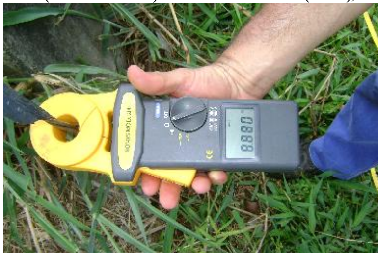
Figura 6: Obtenção da resistência do aterramento de um poste de distribuição, através do uso do terrômetro alicate.
