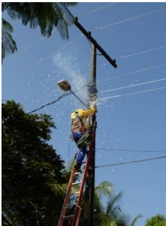
FIGURA 5 – ENSAIOS DE CURTO-CIRCUITO REALIZADOS NAS REDES DE BAIXA E MÉDIA TENSÃO
