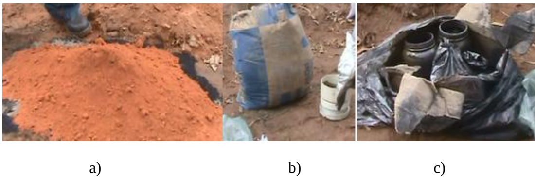
Figura 5: Mistura do solo local com produto e adição de cimento e carbono grafite.
