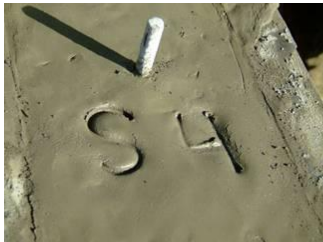
Figura 3. Foto ilustrativa do eletrodo mantido externo ao concreto para a realização de medidas eletroquímicas como do potencial de corrosão da armadura.
