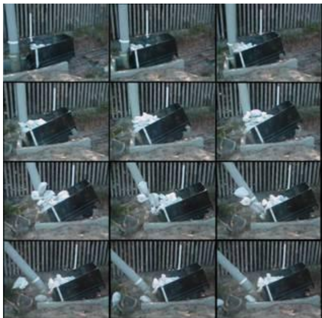
Figura 7. Frames do momento do impacto no poste de fibra.
