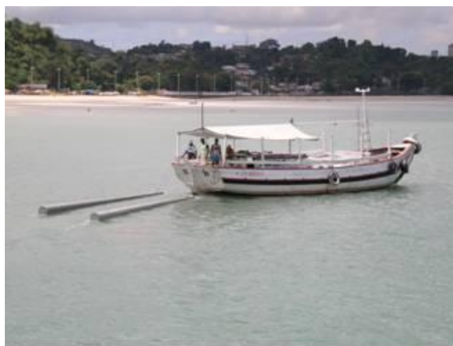
Figura 9. Transporte de postes em compósito via marítima.
