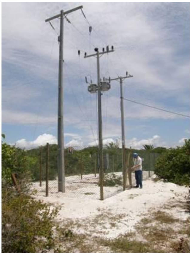
Figura 10. Conjunto de postes em concreto e composto sendo estudado em estação de intemperismo natural localizada a 150 m da praia, na região de Saúpe, BA.
