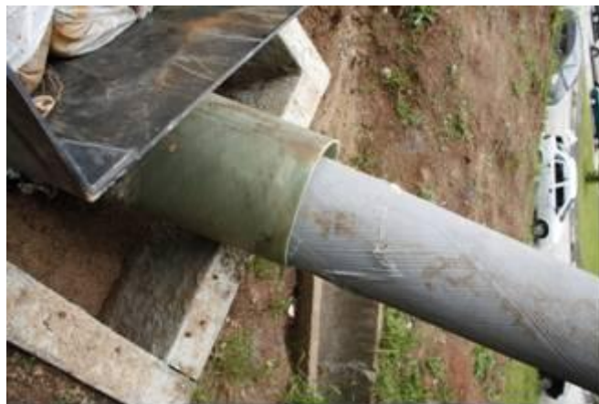
Figura 8. Sistema de proteção anti-impacto desenvolvido e sua deformação após o teste de colisão efetuado.
