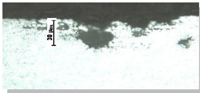
Figura 5. Micrografias por microscopia óptica, identificando pite na superfície de uma placa de alumínio da ECA AML com 2 anos de exposição atmosférica.
