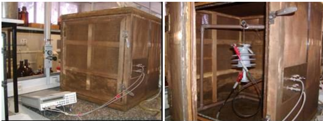
Figura 4. Arranjo experimental utilizado para as medidas de resistência de isolamento em isoladores.
